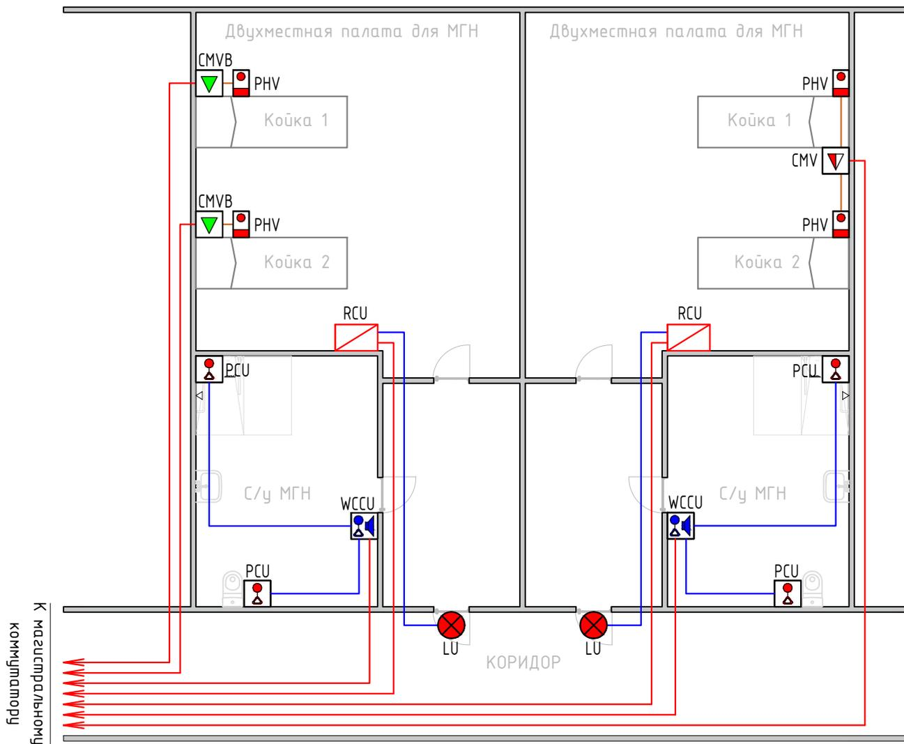
Подключение прикроватного пульта пациента с голосовой связью, серии LX "LXPHV-IP-A0122" возможно с помощью модуля "LXCMVB-IP-A0122" или "LXCMV-IP-A0122".
